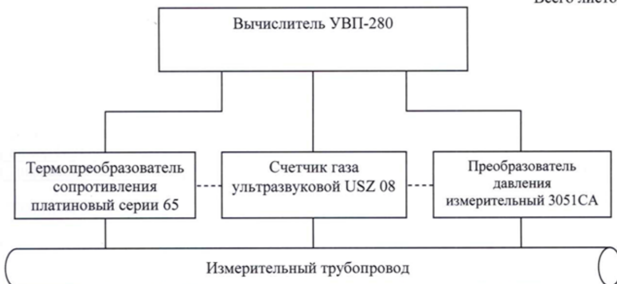
Рисунок 1 Обобщенная структурная схема комплексов измерительных RMG-УВП.
